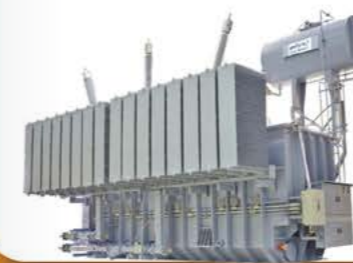
ترانسفورماتور نیروگاه سیکل ترکیبی دو کوره بسیستم خنک کننده ODAF توان 385 MVA، ولتاژ ۲۰/۲۴۵ kV
