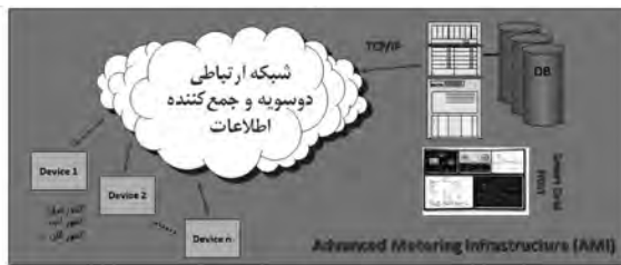
شکل ۱- نمایی کلی از شبکه کنتور های هوشمند
