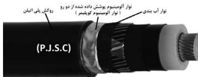
شکل ۶: نمونه کابل تولید شده با آلومینیوم کوپلیم و روکش پلی اتیلن به همراه نوار نیمه‌هادی آب بندی بین آلومینیوم کوپلیم و اسکرین
